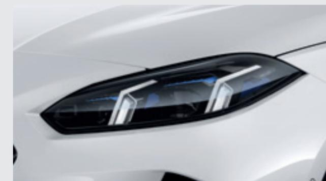
**Pack Advanced Full LED** : L'équipement comprend une gestion automatique des feux de route. La fonctionnalité anti-éblouissement "BMW Selective Beam" avec projecteurs directionnels répartit de façon variable le faisceau lumineux pour un éclairage optimal de la route dans l'obscurité.
